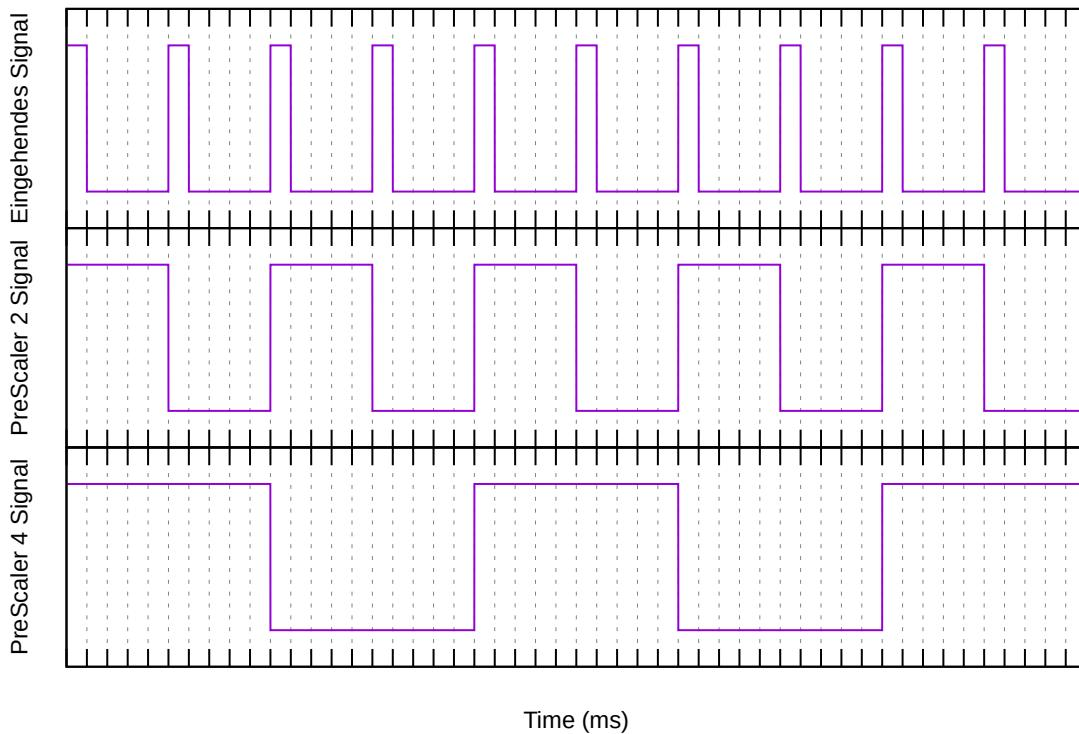
Abbildung 7.1.: Zu messendes Eingangssignal und damit erzeugte Prescaler Signale
