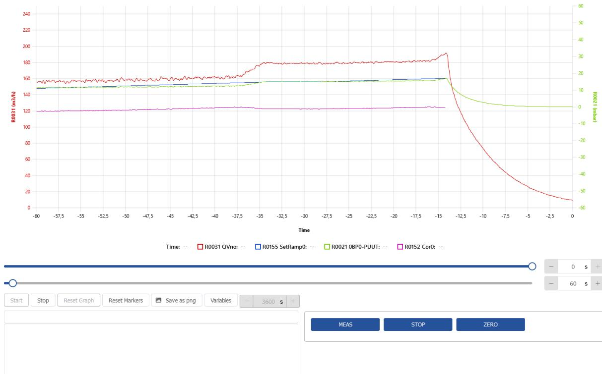
Der eigentliche Grafik-Bereich kann wie ein Plotter aufgefasst werden, dessen Papier bei gestarteter Grafik von rechts nach links läuft. Es können bis zu 10 Parameter dargestellt werden.
