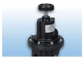
Der Präzisionsdruckregler M4000A ist ein direktwirkender Proportionalregler mit Regelbereichen zwischen 0,035 und 17 bar Überdruck und Durchflussraten von 4200 NI/min bei 7 bar Eingangsdruck.
