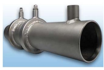
Das Venturirohr H800 wird eingesetzt bei der Durchflussmessung von aggressiven und nichtaggressiven Gasen, Dämpfen und Flüssigkeiten, bei denen es speziell auf niedrigen Druckverlust ankommt.
