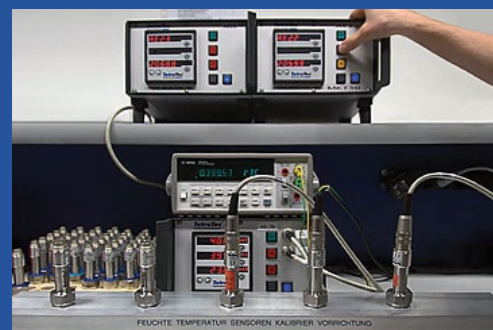
Kalibrier Aufbau mit HUMTMP-Sensor
