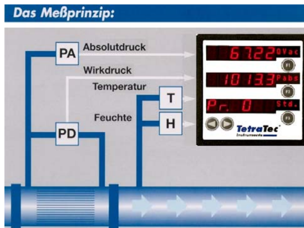
Abbildung 10: Laminar Flow Elemente, Auswerteschema
